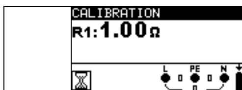
Rysunek 5.14: Wyniki ze starymi wartościami kalibracji
