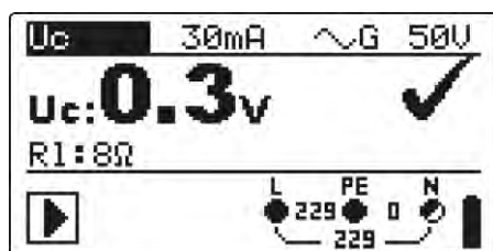
Afbeelding 5.18: Voorbeeld van de meetresultaten van de aanraakspanning
