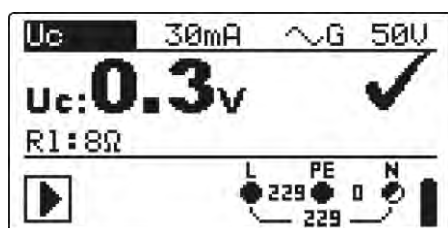
Figure 5.18: Exemple de résultats de mesure de la tension de contact
