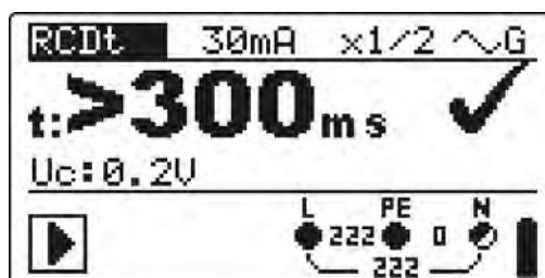
Figure 5.19: Exemple de résultats de mesure du temps de déclenchement
