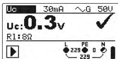
Rysunek 5.18: Przykład wyników pomiaru napięcia stykowego
