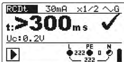
Figur 5.19: Exempel på mätresultat för utlösningstid
