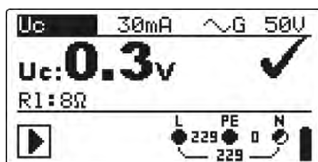
Figura 5.18: Ejemplo de resultados de medición de la tensión de contacto
