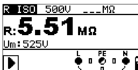
Rysunek 5.7: Przykładowy wynik pomiaru rezystancji izolacji
