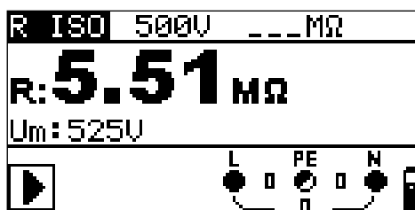
Afbeelding 5.7: Voorbeeld van het meetresultaat van de isolati weerstand
