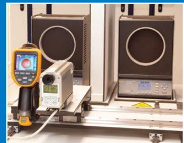
Calibrage de la thermographie
