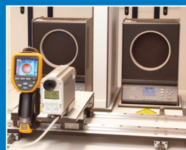
Calibrage de la thermographie
