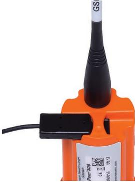
Fig. 5: Raccordement du câble de communication sur le **SePem 300**
