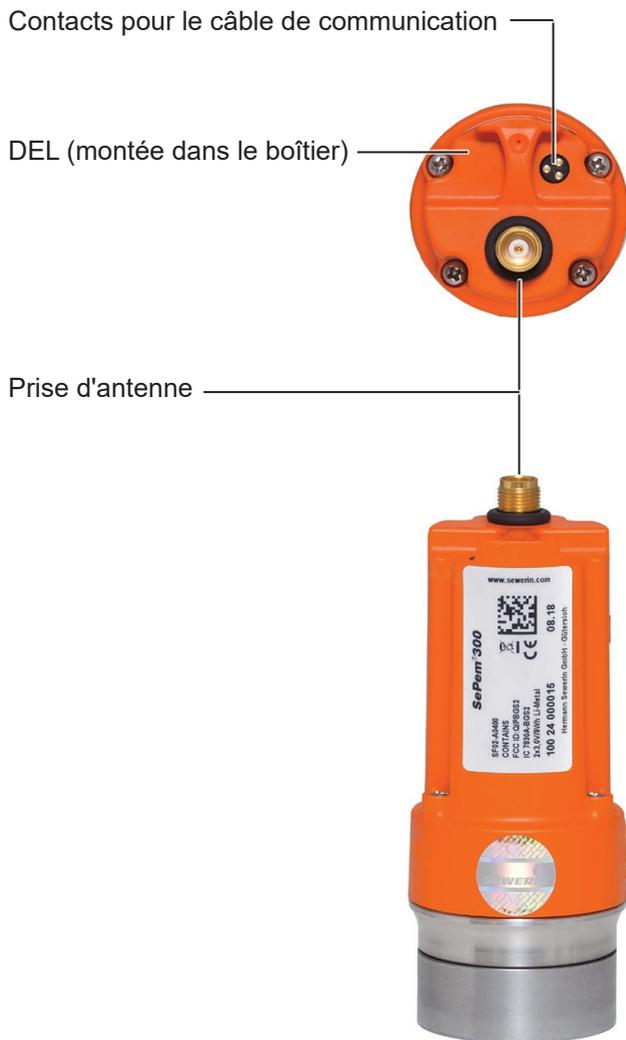
Fig. 2: **SePem 300** sans antenne
