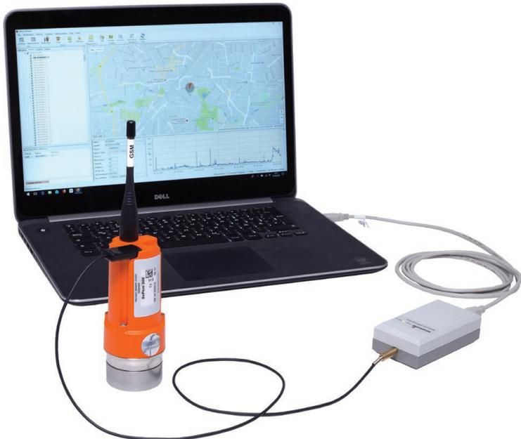
Fig. 4: Installation du système pour la programmation du logger
