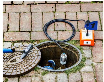
Corrélation avec l'émetteur radio RT200 et le micro universel UM 200
