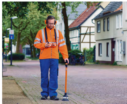
Localisation avec SeCorrPhon AC 200
