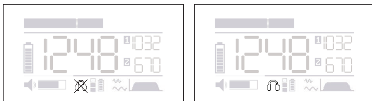
Fig. 9: Symbole de casque lorsque le système est prêt à fonctionner Illustration de gauche : symbole barré, pas de mesure ou seuil de protection auditive dépassé pendant la mesure Illustration de droite : symbole non barré, la mesure est en cours et les bruits peuvent être écoutés
