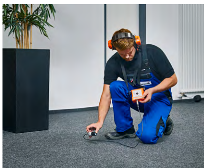
Localisation de conduite avec le récepteur AF 50 et la bobine de recherche SK3
