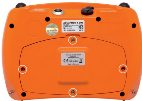
Fig. 32: Arrière du récepteur A 200 Cercles blancs : vis du couvercle du compartiment à piles
