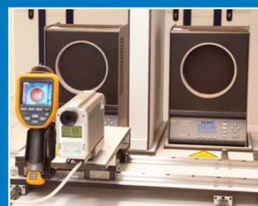
Calibrage de la thermographie
