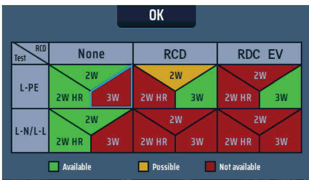
Fig. 51 : Tableau de recommandations des tests de boucle
