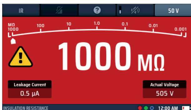
Fig. 21 : Test d'isolement en cours
