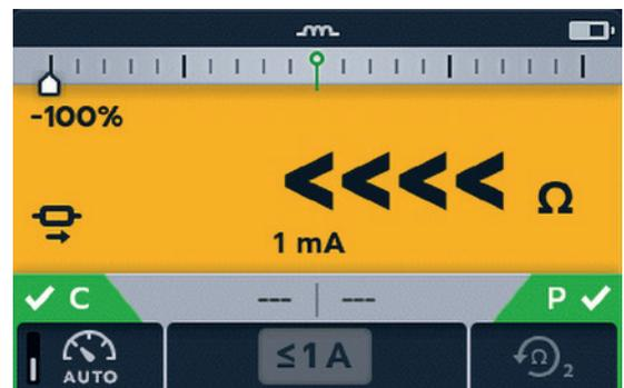
Les mesures sont mises à jour jusqu'à obtention d'une mesure stable, auquel cas l'instrument arrête automatiquement le test. Le test peut également être arrêté à tout moment en appuyant sur le bouton TEST
