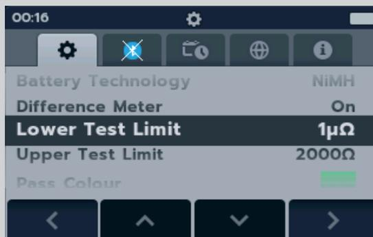
2. Utilisez les touches 1 ou 4 pour déplacer le sélecteur vers la gauche ou la droite et choisir les unités de mesure ainsi que la limite requise. Utilisez les flèches haut et bas (touches 2 et 3) pour sélectionner les chiffres.
