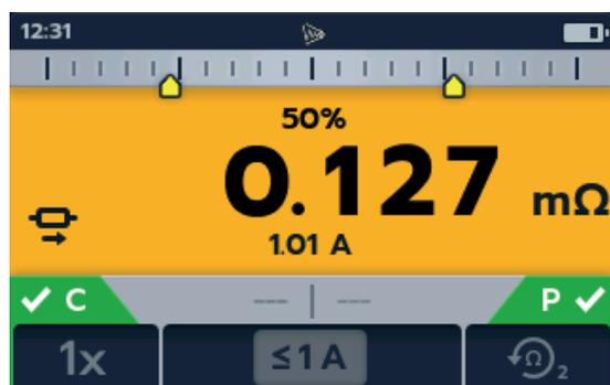
Il peut arriver que la valeur mesurée soit réellement stable, mais que le Confidence Meter™ indique toujours un niveau de confiance inférieur, par exemple 50 %. Dans ce cas, l'utilisateur peut être satisfait de la valeur stable et choisir d'arrêter le test en appuyant sur le bouton TEST. Cela est généralement dû au fait que le Confidence Meter™ tente de résoudre la mesure à une résolution supérieure à celle actuellement affichée.
