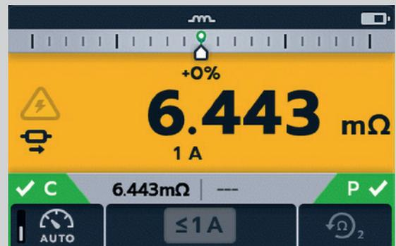
**MISE EN GARDE : Si le relevé est instable, le DLRO peut ne pas s'arrêter automatiquement. L'utilisateur doit alors arrêter manuellement le test.**
