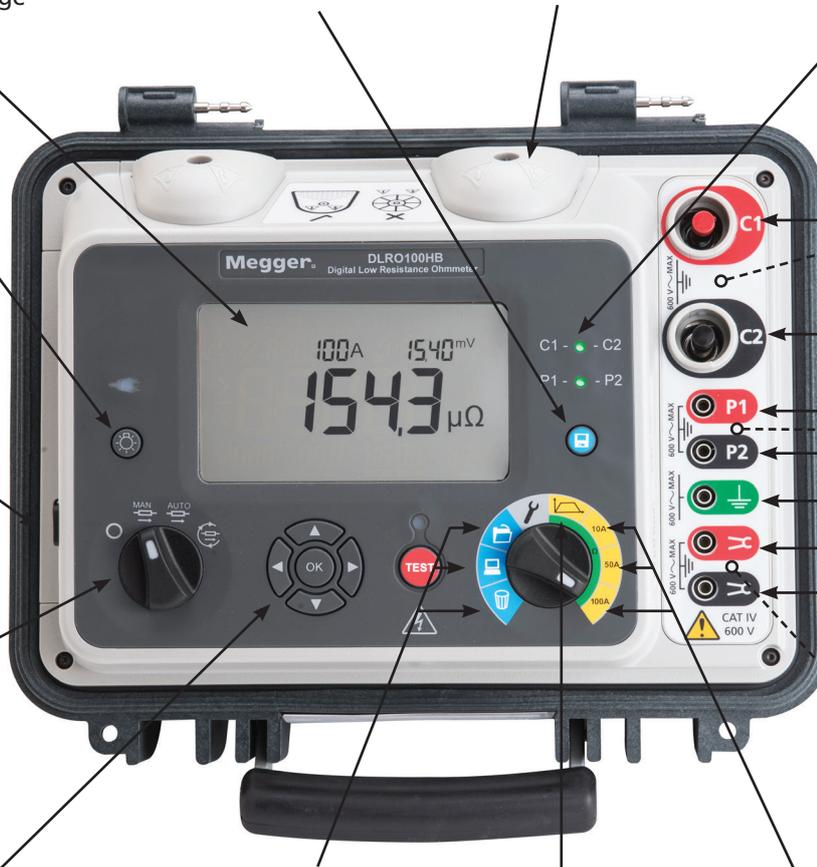
Sortie C.C. régulière sur bornes C1 et C2
