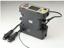
Le DLRO10 et le DLRO10X peuvent être aussi alimentés par le secteur ou par une ligne électrique grâce au module d'alimentation optionnel DLRO10LPU. Ce module est simplement monté sur
