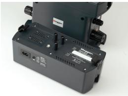
Photo du DLRO10X équipé du module optionnel DLRO10LPU
