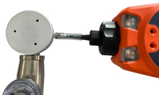
6. À la fin du compte à rebours, une coche « ✓ » apparaît, indiquant que SPAN 1 (ÉTALON 1) a été accepté. Appuyez sur la touche **Entrée**. Pour un étalonnage en deux points, la procédure d'étalonnage est terminée.
