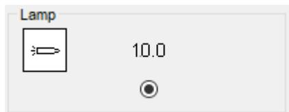
Le TIGER XTS est configuré pour être utilisé avec la lampe 10.0 eV uniquement.
