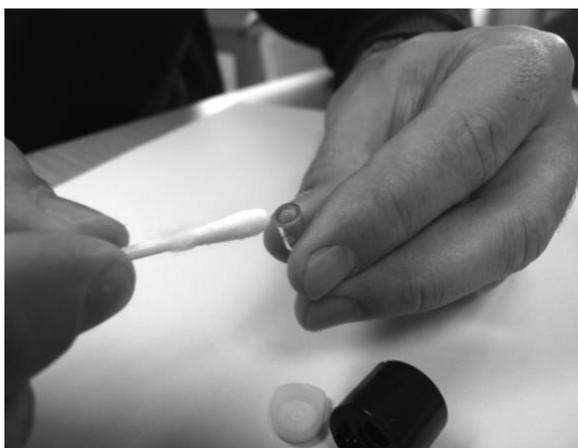
3. Continuez de frotter jusqu'à ce que le coton-tige imprégné de composé produise un bruit de couinement lorsqu'il passe sur la surface de la fenêtre (généralement au bout de quinze secondes).
