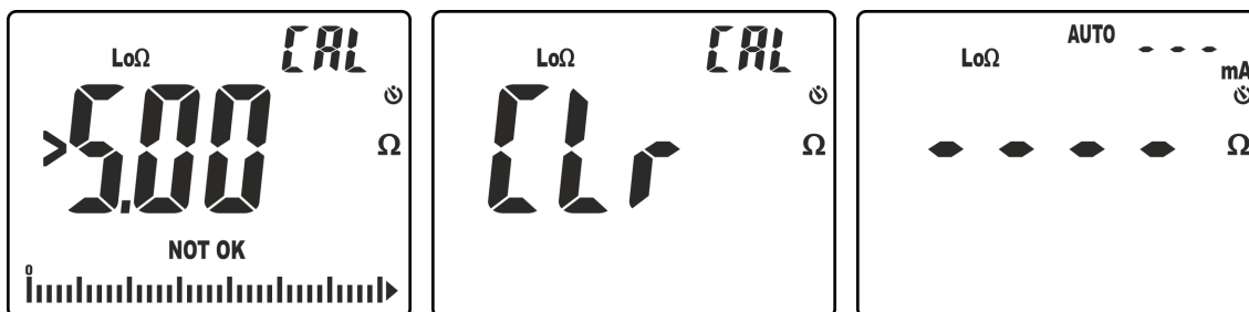
Fig. 34: Résultats remise à zéro pas exécutée correctement
