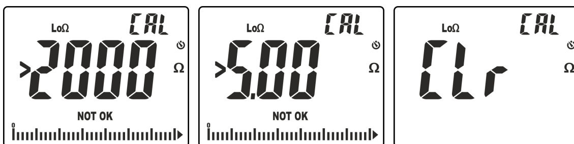
Fig. 35 : Remise à zéro d'un étalonnage
