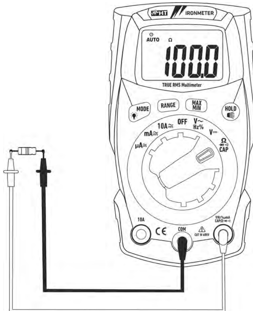
Fig. 5: Uso dello strumento per misura di Resistenza e Test Continuità
