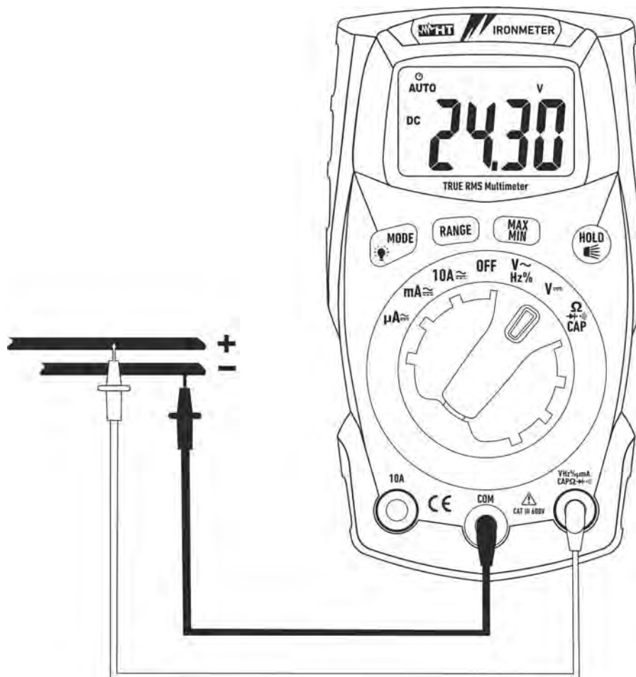
Abb. 3: Verwendung des Gerätes für Gleichspannungsmessung
