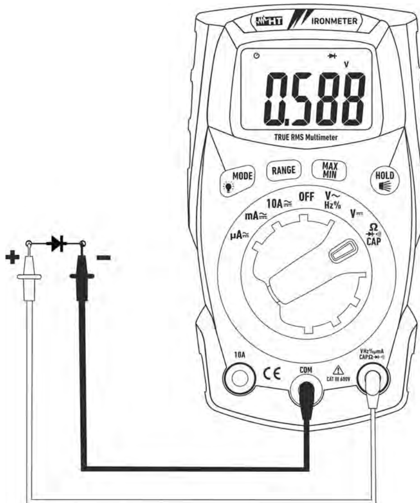
Fig. 6: Utilisation de l'instrument pour le test des diodes
