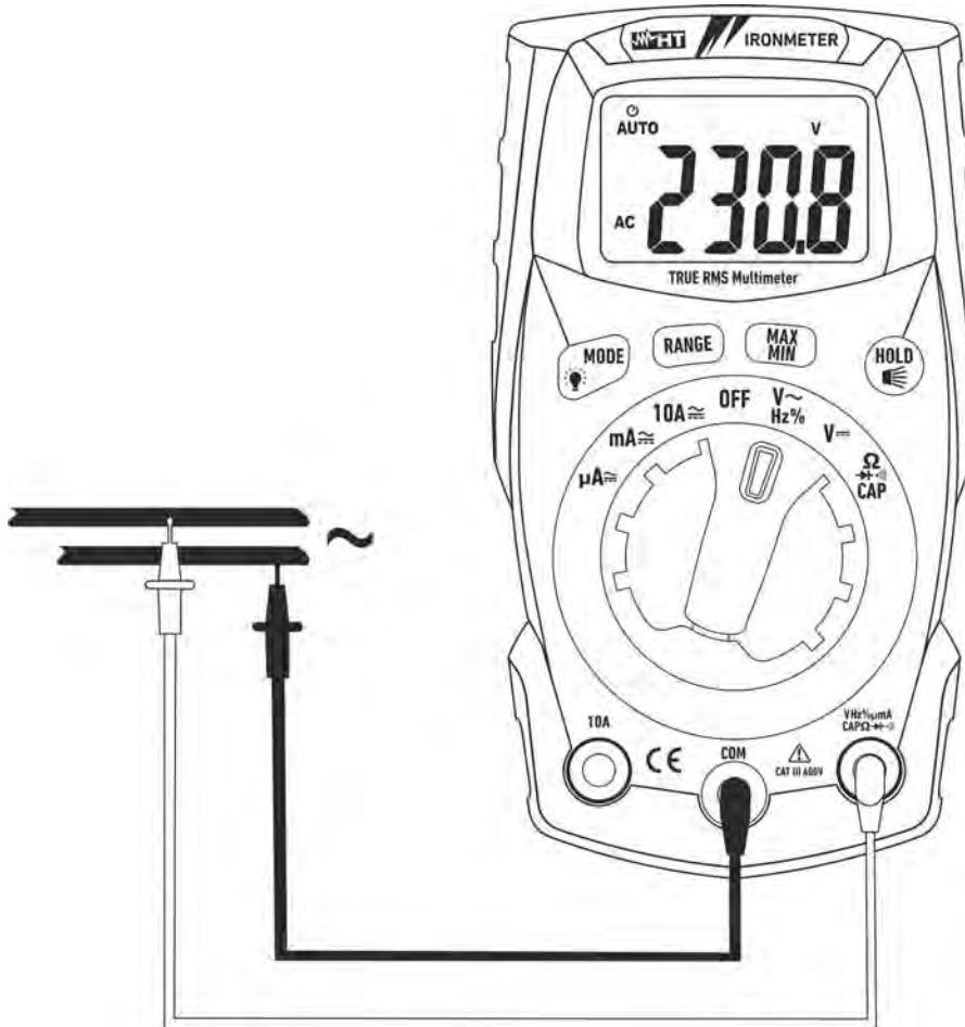
Fig. 4: Uso dello strumento per misura di Tensione AC
