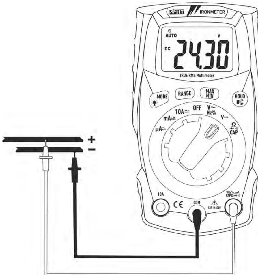
Fig. 3: Utilisation de l'instrument pour la mesure de tension DC
