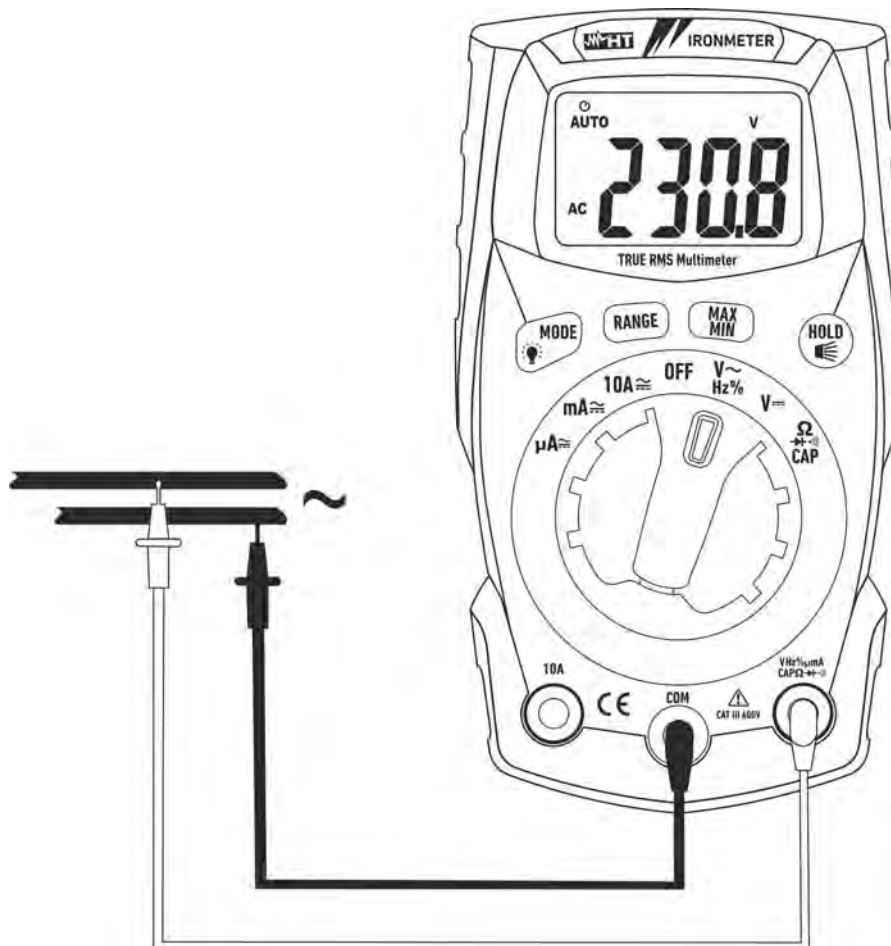
Abb. 4: Verwendung des Gerätes für Wechselspannungsmessung
