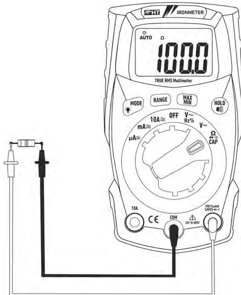
Fig. 5: Uso del instrumento para medida de Resistencia y Prueba de Continuidad
