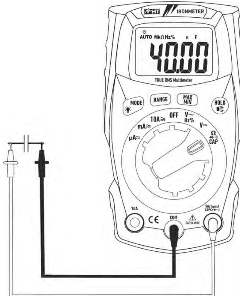
Fig. 7: Uso dello strumento per misura di Capacità
