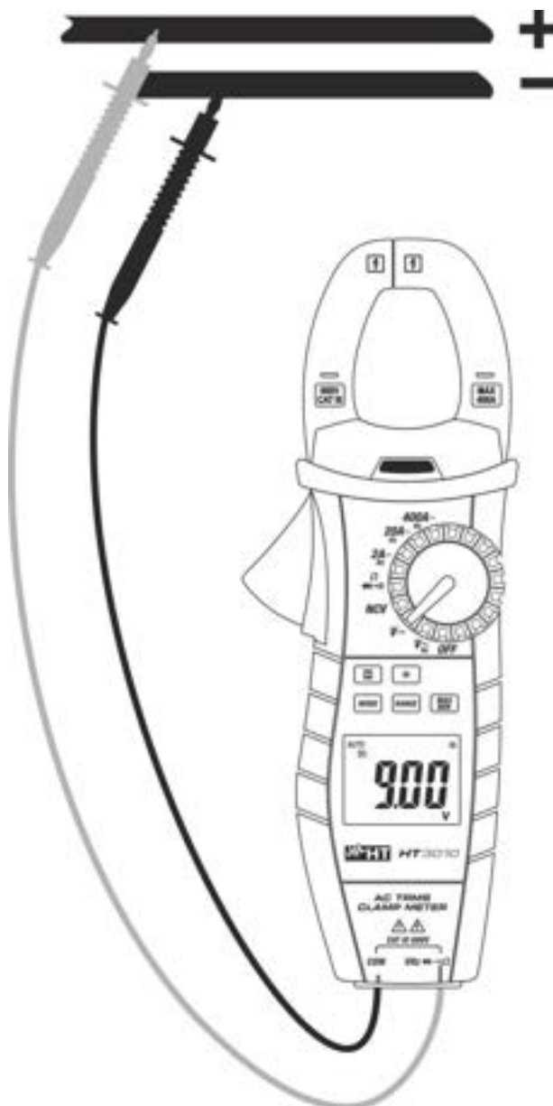
Fig. 3: Uso dello strumento in misura di Tensione DC
