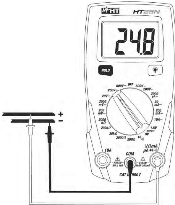
Fig. 2 Use per misura di Tensione DC Taking DC voltage measurements Uso en medidas de Tensión CC DC-Spannungsmessung Utilisation pour tension CC Uso na medição de Tensões CC
