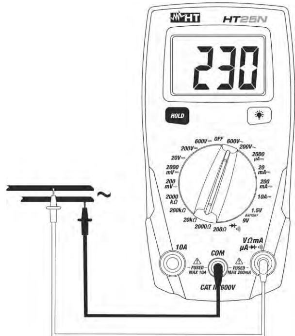
Fig. 3 Uso in misura di Tensione AC Taking AC voltage measurements Uso en medidas de Tensión CA AC- Spannungsmessung Utilisation pour tension CA Uso na medição de Tensões CA
