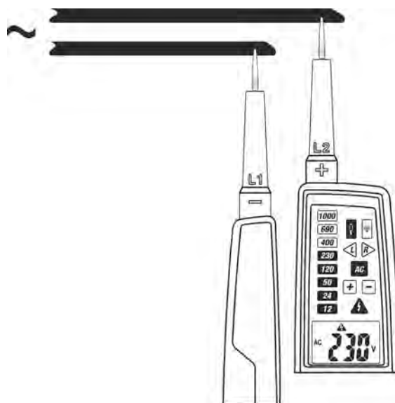
Fig. 6: Medição da Tensão CA com baixa impedância
