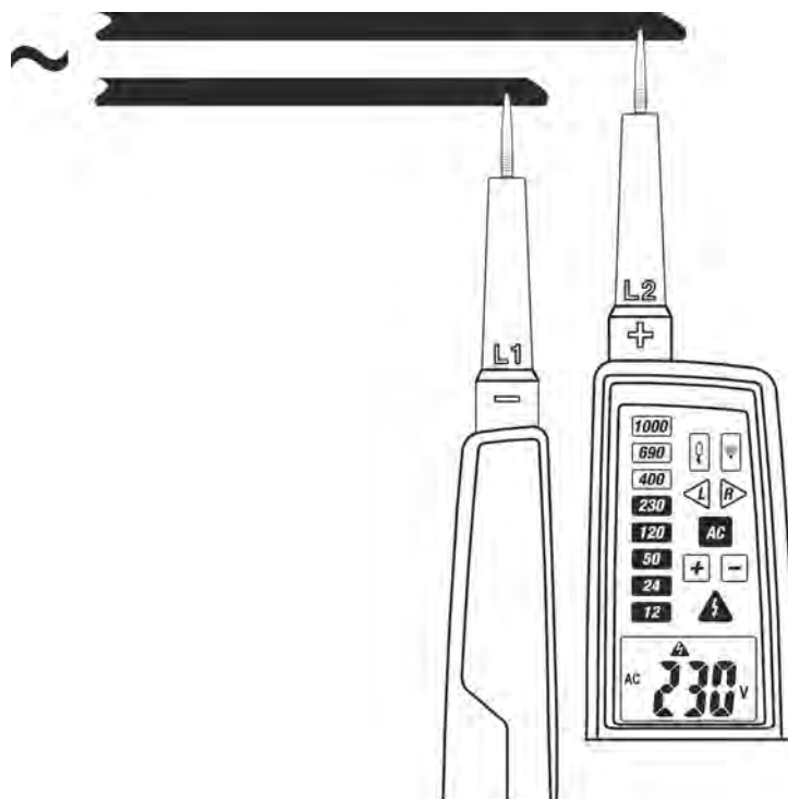
Fig. 5: Medição de Tensão CA
