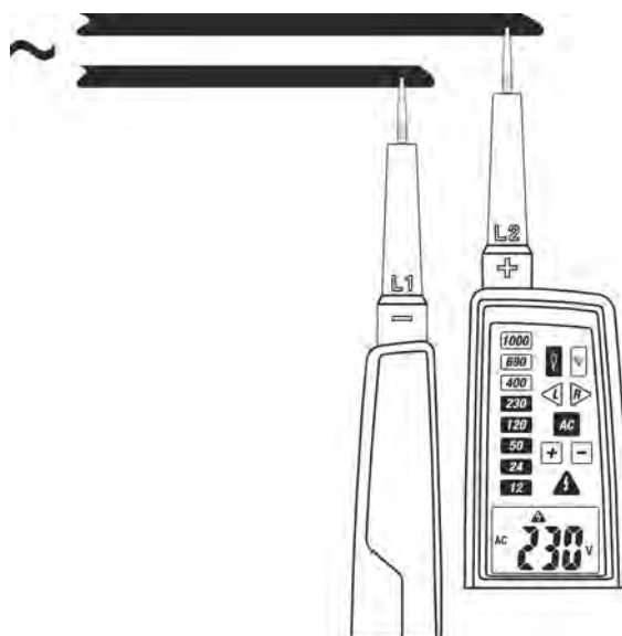
Fig. 6: Medida de Tensión CA a baja impedancia
