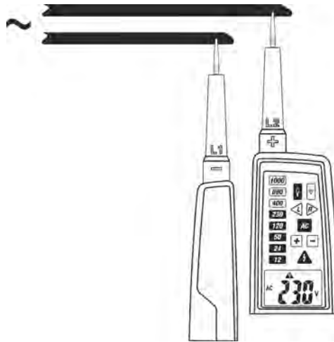
Abb. 6: Messung der AC Spannung mit niedriger Impedanz
