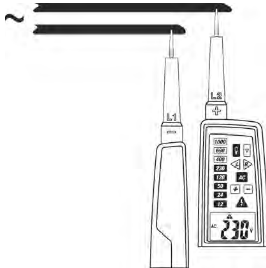
Fig. 6 : Mesure de la Tension CA avec faible impédance
