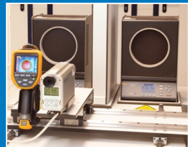
Calibrage de la thermographie
