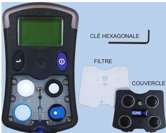
Fig. 4.2 Filtre et couvercle retirés
