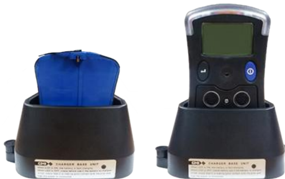
Fig. 4.8 Block-pile / Appareil inséré dans le chargeur rapide
