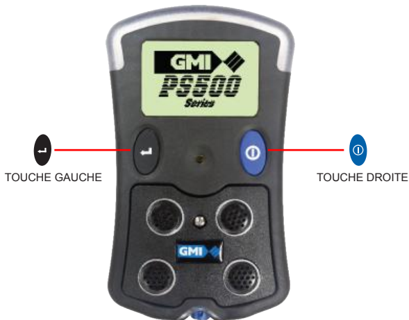
Fig. 2.1 Fonctionnement de la touche du PS500
