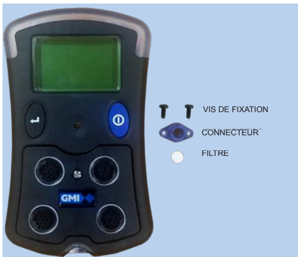
Fig. 4.4 Filtre et connecteur retirés
