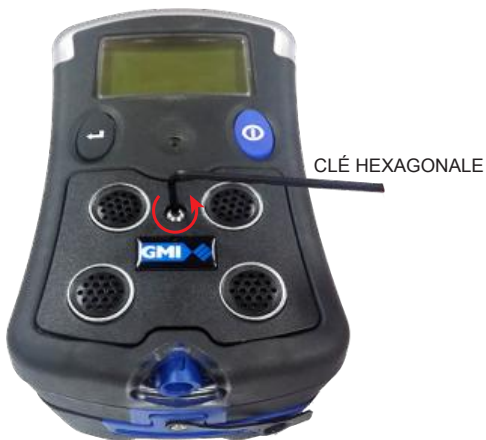
Fig. 4.1 Vis imperdable du couvercle
