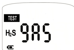
Figure 4-2 : Test fonctionnel manuel – Appliquer le gaz
