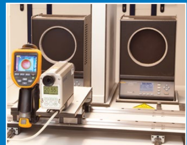
Calibrage de la thermographie
