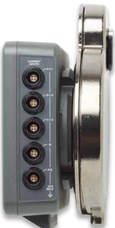
Entrées de courant pour l'installation de sondes de mesure à l'intérieur du panneau électrique
