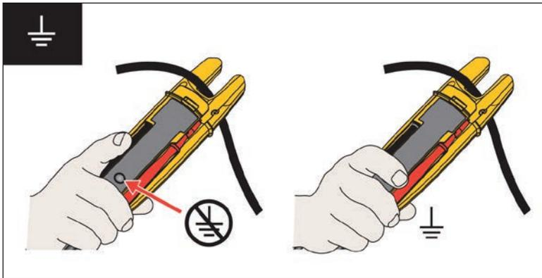
La technologie FieldSense constitue un trajet capacitif entre un point de contact à l'arrière du testeur, la main de l'opérateur et la mise à la terre.
