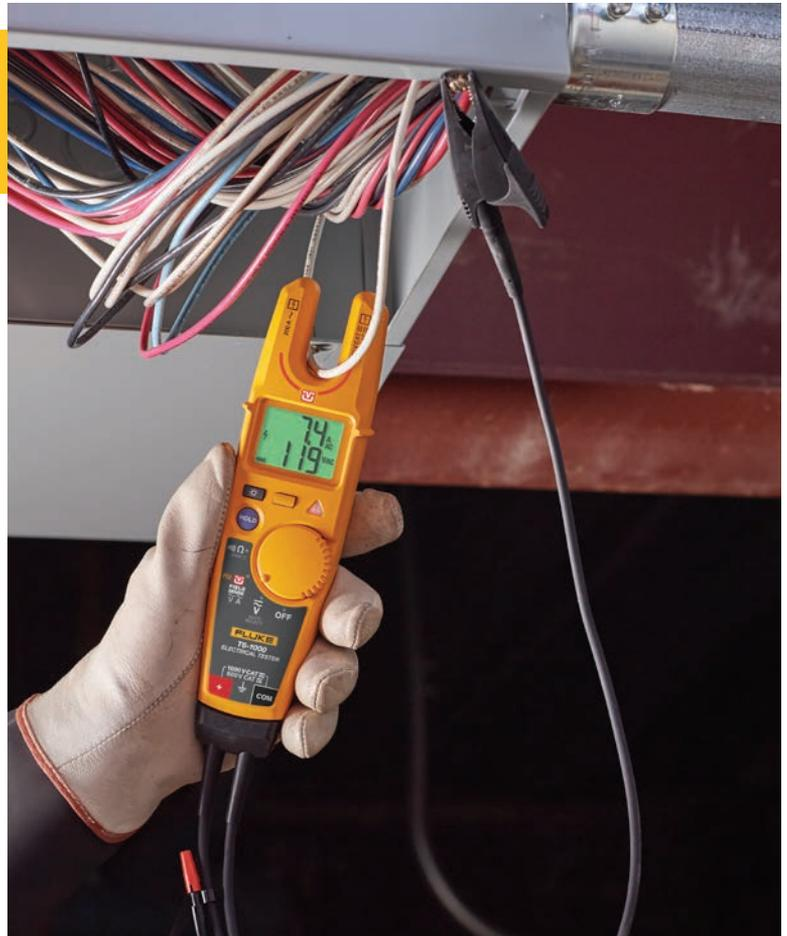
Et comme la mesure est réalisée au travers des isolants du câble, l'exposition aux conducteurs métalliques est réduite. De cette manière, le risque d'erreurs, notamment de contacter le mauvais conducteur, est également réduit.
