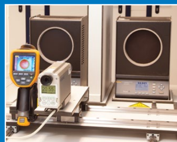
Calibrage de la thermographie
