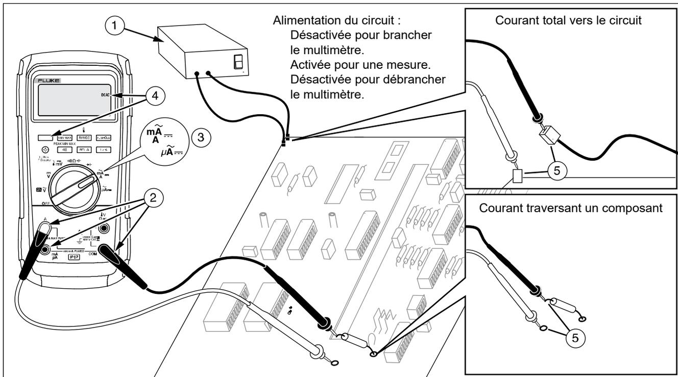
Figure 8. Mesures de courant
