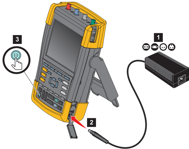
Figure 1. Mise sous tension de l'outil de diagnostic
