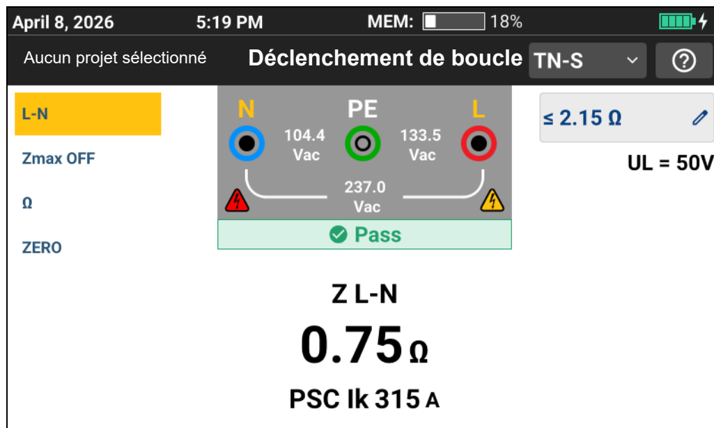
Figure 13. Ecran de mesure de l'impédance de ligne
