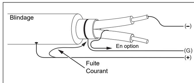
**Figure 3. Branchement de la borne de protection**
