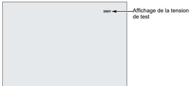
2. Appuyez sur **▲** ou **▼** pour faire défiler les tensions de test prédéfinies (250 V, 500 V, 1000 V, 2500 V, 5000 V et 10 000 V).
