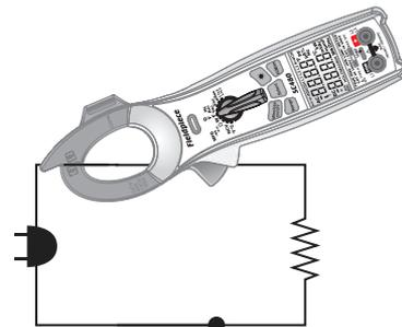
L'intensité CA (ACA), la fréquence (Hz) dans la pince et le courant Inrush ACA sont mesurés dans la position du commutateur sur VCC/AAC/Hz indiquée ci-dessus.
