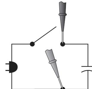
**Déchargez les condensateurs avant les tests!**
