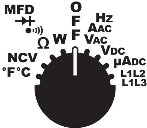
Le SC480 intègre les paramètres de mesure indispensables pour les professionnels de la climatisation (CVCR). Sélectionnez le paramètre que vous souhaitez mesurer avec le cadran de sélection rotatif.
