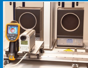
Calibrage de la thermographie
