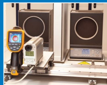
Calibrage de la thermographie
