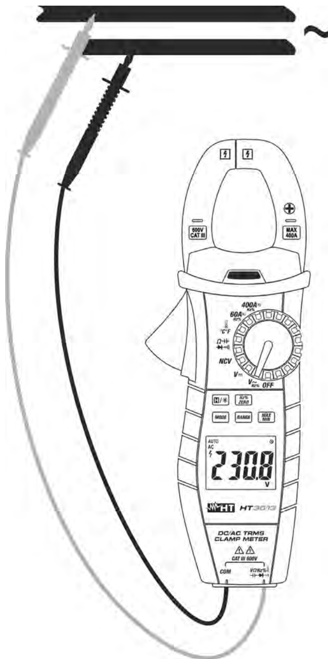
Fig. 5: Utilização da pinça na medição de Tensões CA
