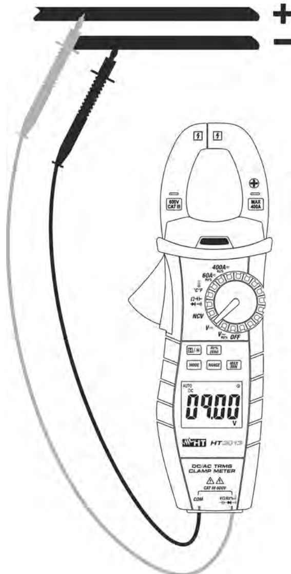
Abb. 3: Verwendung der Zange für Gleichspannungsmessung
