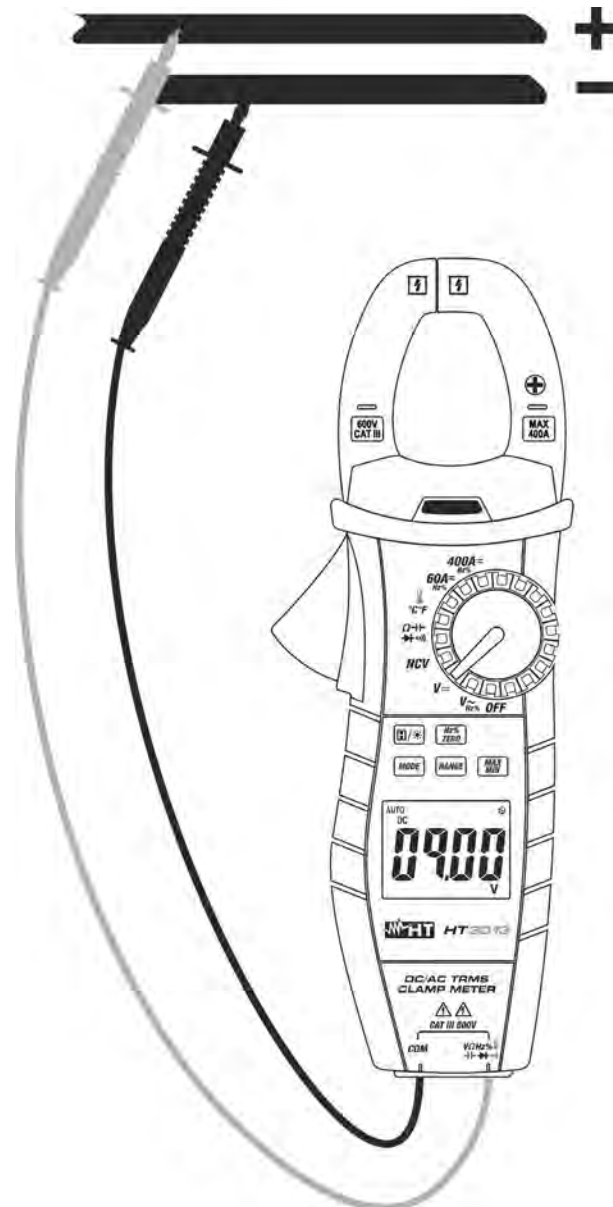
Fig. 3: Uso del instrumento en medida de Tensión CC
