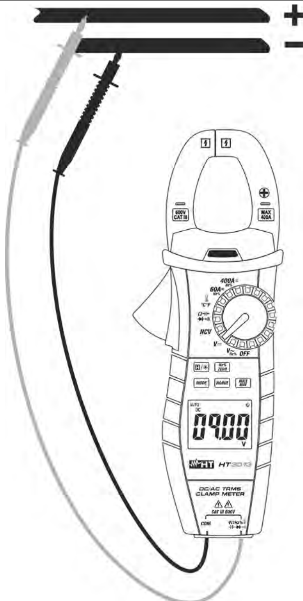
Fig. 3: Utilização da pinça na medição de Tensões CC
