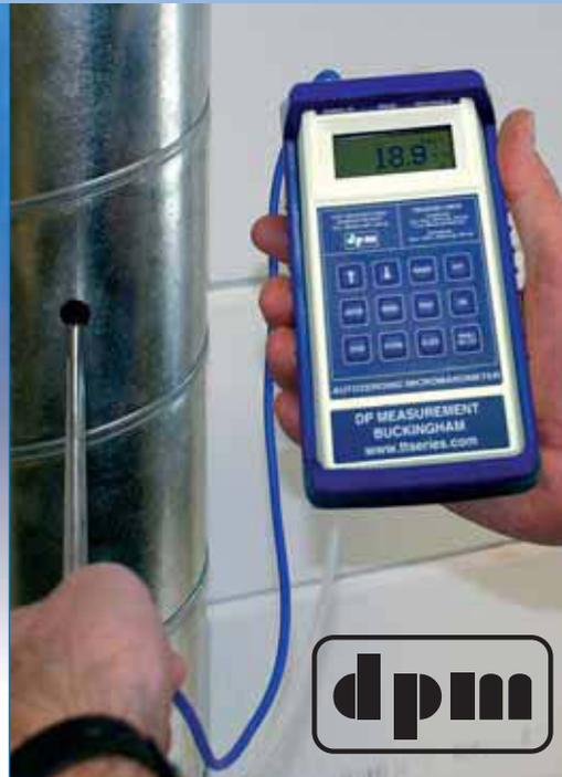
La plupart des modèles de la série TT570 sont conçus pour mesurer les différences de pression, la vitesse de l'air et, dans certains cas, le débit d'air en combinaison avec un tube de Pitot.
