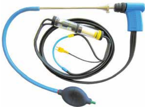
fig. 6 : Configuration de mesure avec set de contrôle d'étanchéité par échantillonnage
