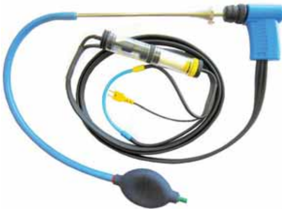
fig. 10: Meetopstelling met monstername dichtheidscontrolezet
