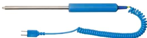
X17 thermocouple avec cordon bouclé
