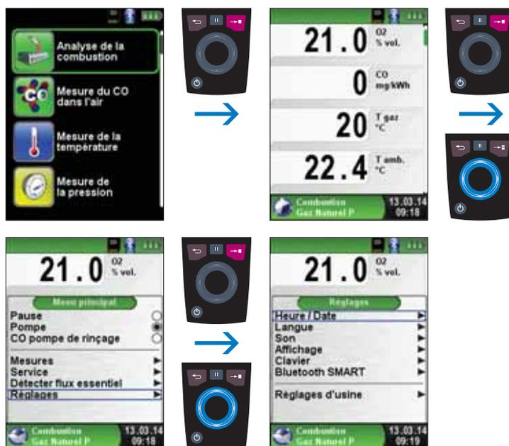
fig. 50 : Accès à la fonction « Réglages » via le Menu principal (ex. : Combustion)
