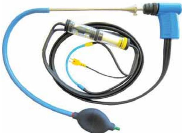
fig. 10 : Configuration de mesure avec set de contrôle d'étanchéité par échantillonnage
