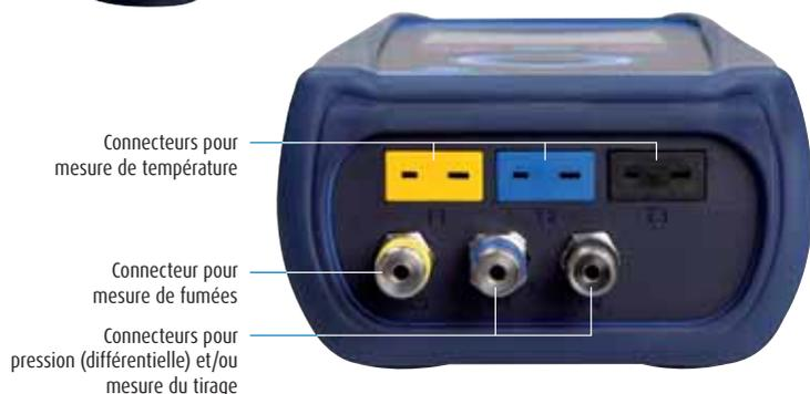
fig. 7 : Dessous de l'instrument
