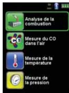
fig. 11 : Sélection de fonction (ex. : Analyse de la combustion)
