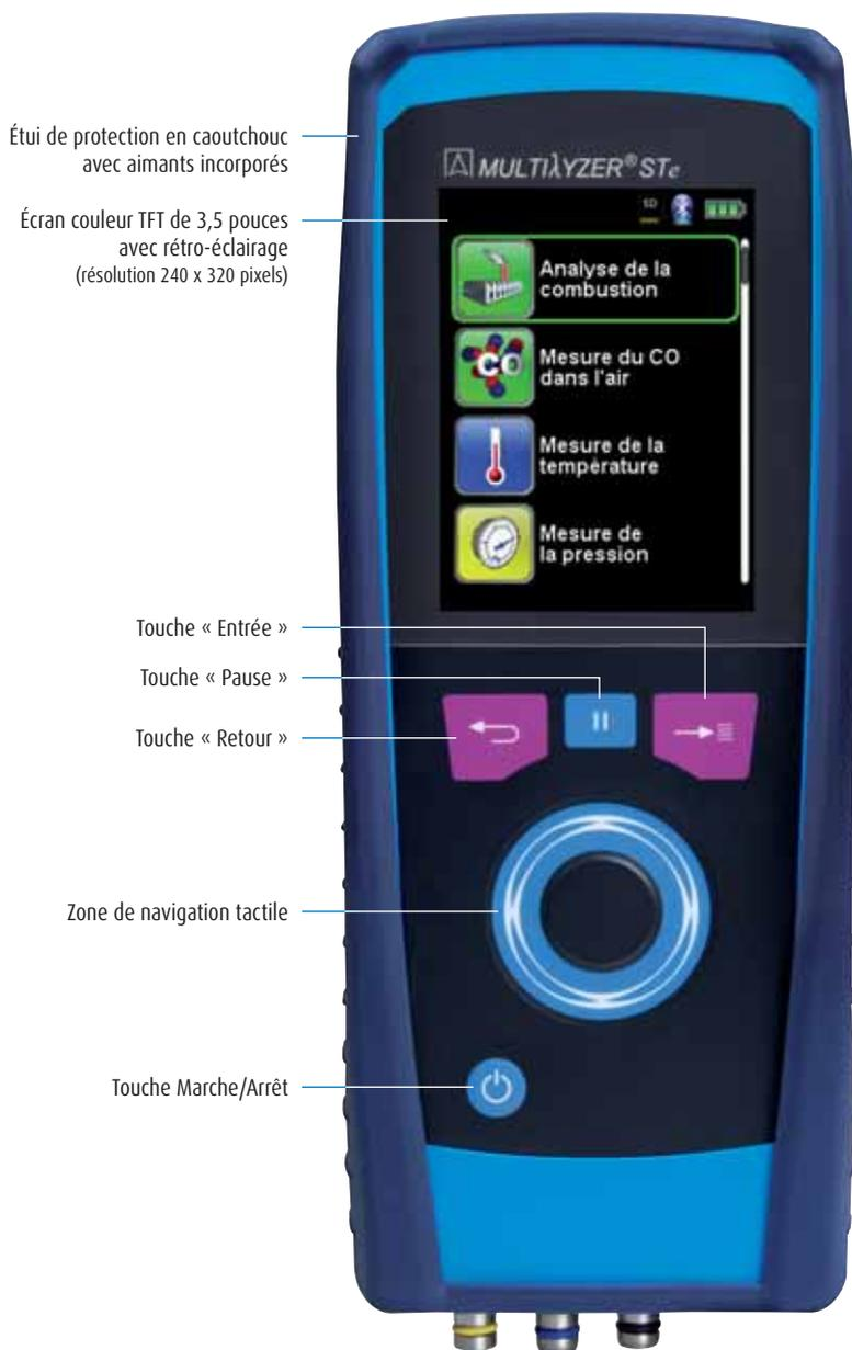
fig. 5 : Face de l'instrument
