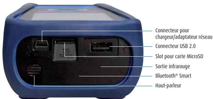
fig. 6 : Dessus de l'instrument
