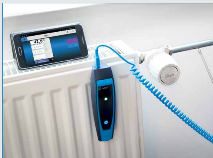
Temperatuurmeting bij een cv-leiding met aflezing met een smartphone met de EuroSoft live app
