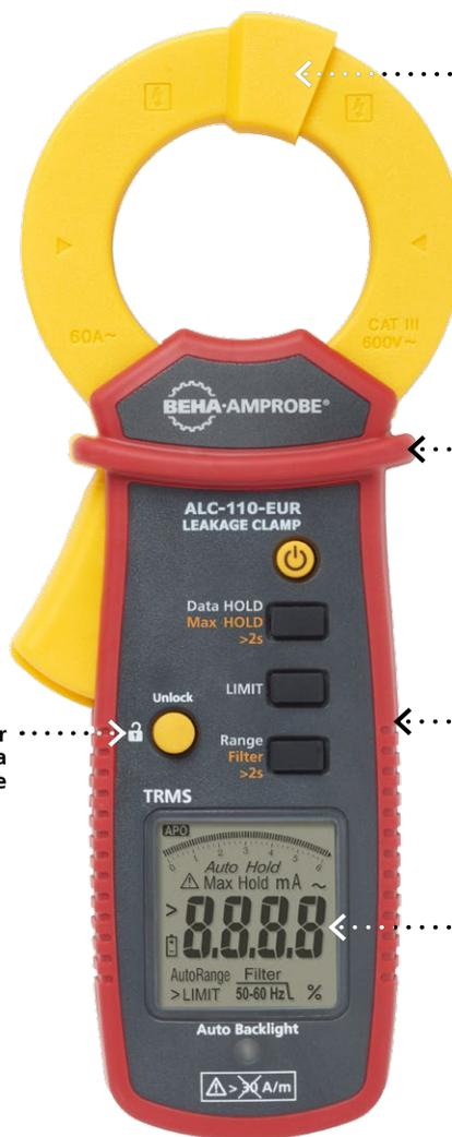
← ..... Blocage mécanique ; pince étroite pour plus de précision, permettant d'éviter les perturbations causées par les câbles mesurés et les champs magnétiques
