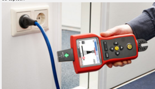
Détection de tension sans contact (NCV).
