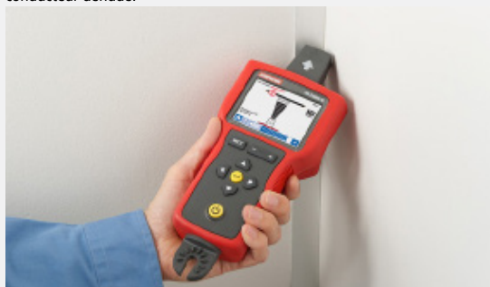
Traçage de câbles dans des zones difficiles d'accès avec la pointe du capteur.
