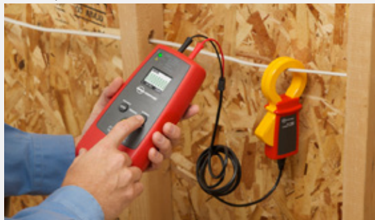
Induction de signal avec la pince de signal en l'absence de conducteur dénudé.
