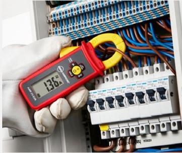
**Dépannez les systèmes électriques** et mesurer les courants de charge alternatifs/ continus des câbles exposés dans un tableau à disjoncteurs.
