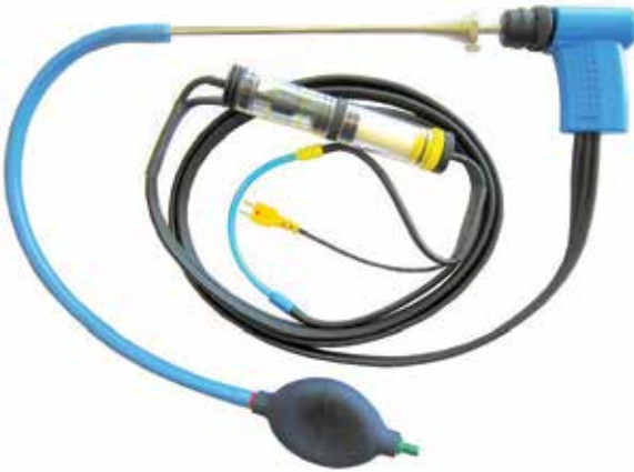
fig. 6: Meetopstelling met monstername dichtheidscontrolezet
