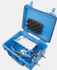
Coffret de pression conduites de service
